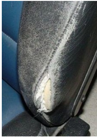
Exemples de cuirs trop cassés ou trop vieux pour une réparation.
