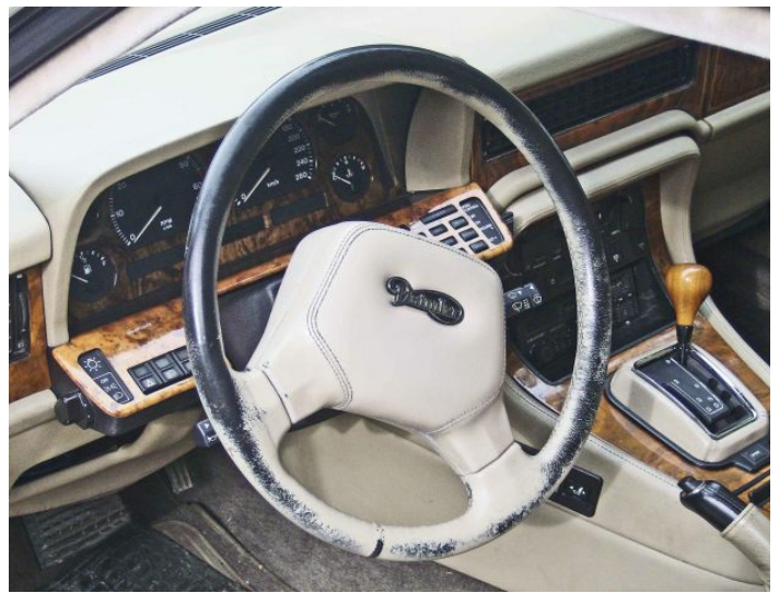
Volant extrêmement gras. Il est préférable de consulter un prestataire professionnel ou de faire changer le cuir
