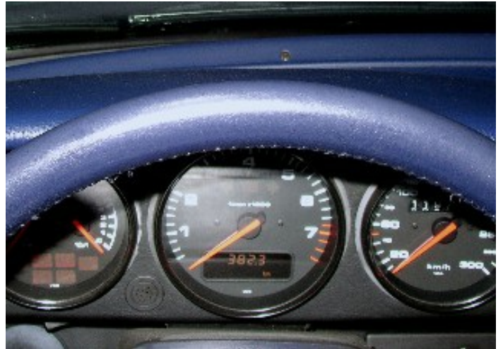
Après la rénovation à l'essence de nettoyage, au tampon abrasif et à la coloration Leather Fresh
